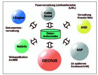
Für GEONIS relevante Systemumgebung bei Cablecom.
