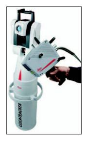
Scan: «Dies ist die weltweit erste echte universelle KMG-Lösung (Koordinatenmessgerät) für grosse Messvolumen. Ihr Einsatz eröffnet unseren Kunden völlig neue Möglichkeiten. Kein anderer Anbieter auf dem Marktverfügt über eine komplette Lösung, die bei diesem grossen Messvolumen Lasertracking mit Abtast- und Scan-Funktionen kombiniert.» Dr. Jürgen Dold, Vizepräsident für
