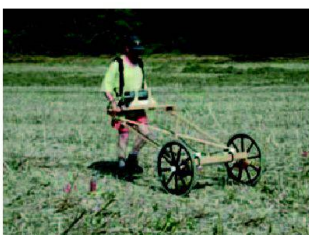
Abb. 3: Magnetikwagen zur schnellen Kartierung von Störungen des Erdmagnetfeldes.
