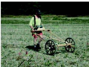
Abb. 3: Magnetikwagen zur schnellen Kartierung von Störungen des Erdmagnetfeldes.
