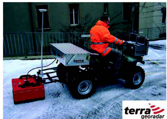
Abb. 1: Quad mit aufgebautem Georadar und einer roten 200-MHz-Antenne.
