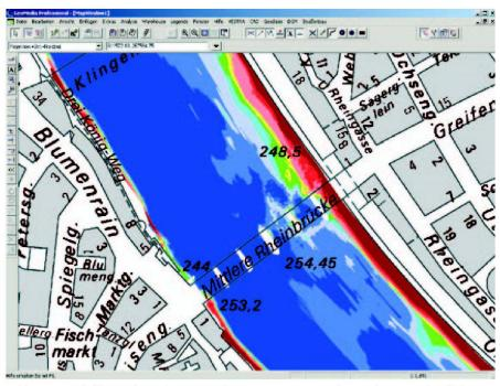
Abb. 1: Modellverschneidung, Tiefenzonen zur Prüfung der Mindestfahrrinnentiefe.
