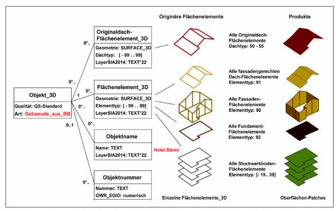
Abb. 1: Auszug Datenmodell «Gebaeude\_aus\_BB»: 3D-Gebäude entsprechend der Grundrissinformation aus der «Bodenbedeckung» der Amtlichen Vermessung.
