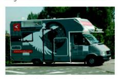
Abb. 1: Mobile Mapping-Fahrzeug zur digitalen Datenerfassung.
