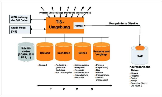
Abb. 4: Aufbau eines integrierten TIS mit Anbindung an SAP.
