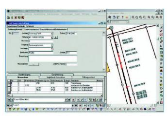
Die Sanierung schadhafter Haltung wird mit dem TB-Sanierungsmodul am Bildschirm vorbereitet.
