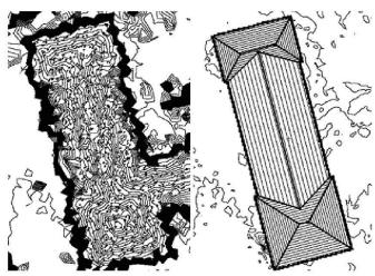
Abb. 2: Links: Höhenlinien gerechnet aus LIDAR-Punkten innerhalb eines Gebäudeumrisspolygons. Rechts: Halbautomatisch abgeleitete 3D-Dachstruktur.
