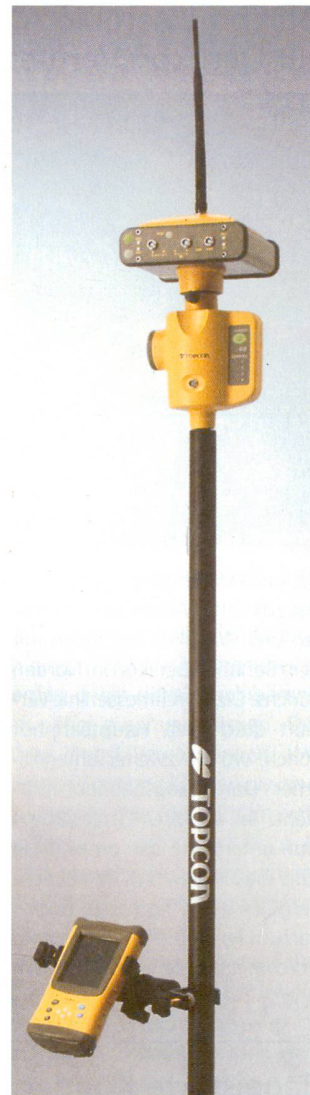
Bluetooth HiPer mit Laserempfänger PZS-1.
