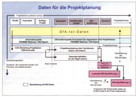
Abb. 5: SBB-Projektierungsprozess mit der DfA.
