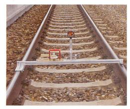
Abb. 7: Gleislehre zur Aufnahme der Ist-Gleislage.
