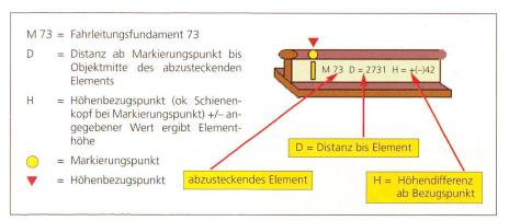
Abb. 6: Rückversicherung eines neuen Fahrleitungsmasten.
