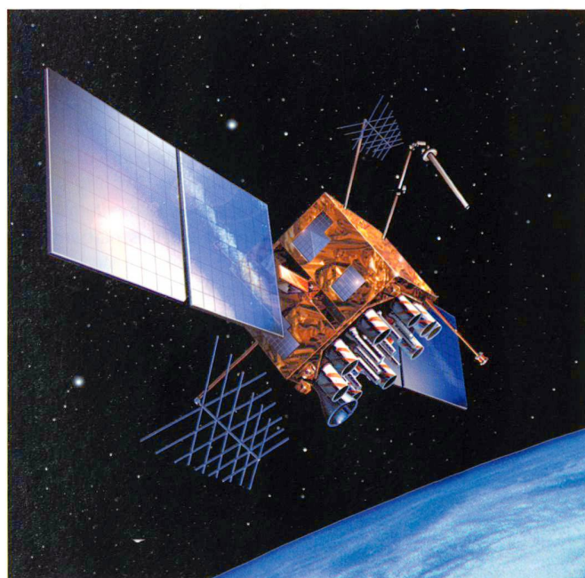
Abb. 1: Block IIR GPS-Satellit heute.
