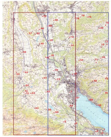
Abb. 3: Untersuchungsgebiet Thun. Dargestellt sind die Abdeckungen des Stereo-Paars und die des Triplets sowie die gemessenen Passpunkte. Grundlage ist die PK 1:25 000, Blätter 1187, 1207 (PK25 © 2004 swisstopo BA046401).
