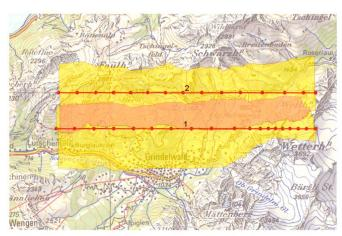
Abb. 5: Die rote Fläche zwischen den Fluglinien zeigt die berechnete Querüberlappung zwischen den benachbarten Fluglinien.
