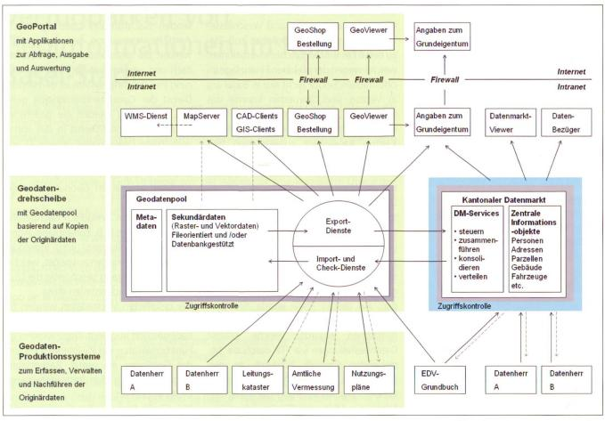
Abb. 2: Schematische Darstellung des Datenaustausches zwischen Originärsystemen, Geodatendrehscheibe, kantonalem Datenmarkt und dem GeoPortal.
