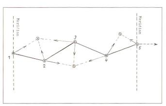
Abb. 6: Mögliches Verfahren zur Einmessung von topographischen Objekten.
