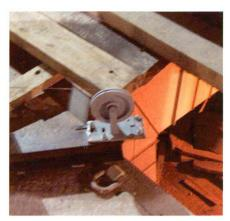
Abb. 3: Umlenkrolle mit Lotdraht.
