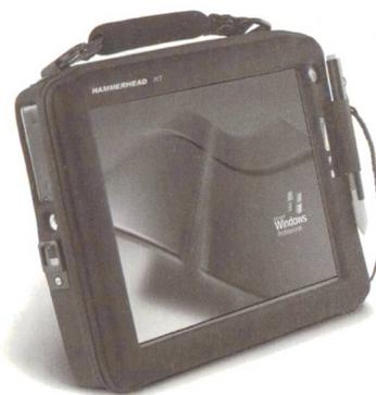
Mobile Intel® Pentium® III 800/933MHz mit 256 oder 512 MB RAM und 20 oder 40 GB stossgesicherte und rotierende HDD, 10,4" Display SVGA 800x600, All-Vis-Technologie für den Einsatz in Innenräumen und im Aussenbereich (direktes Sonnenlicht)! Viele flexible Kommunikations- und kabellose Anschluss-Optionen erhältlich.
