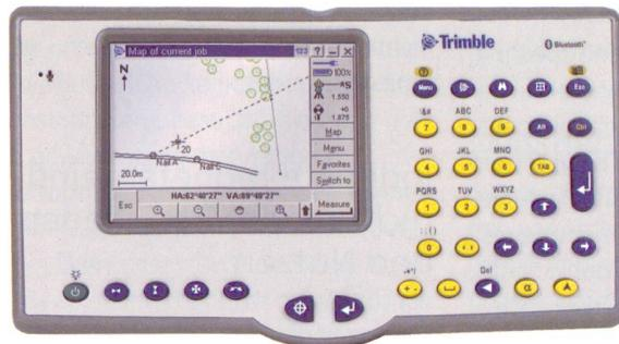
Die ACU-Bedieneinheit von Trimble liefert farbige Informationen über einen Farbtouchscreen. Die einheitliche Bedienung von GPS und Tachymeter erleichtert die Positionierung und beschleunigt die Absteckung und die Datenauswahl. Übrigens – bei Trimble keine Weltneuheit, sondern seit Jahren Teil einer zukunftsweisenden Generation von innovativen Instrumenten, die optimal miteinander kompatibel sind.
