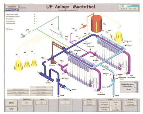
Abb. 2: Übersichtsschema der Ultrafiltrationsanlage Muotathal.
