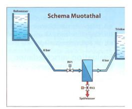
Abb. 1: Schema Druckverhältnisse (Quelle: Membratec AG, Sierre).
