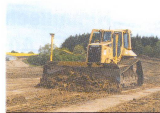
Caterpillar Raupe D6N mit installiertem SiteVision GPS.
