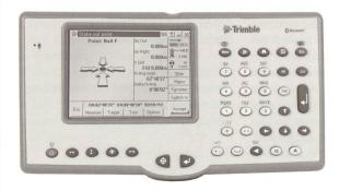
Unser Prinzip des **Integrated Surveying**™ führt zu grösserer Effizienz bei der Erledigung Ihrer Aufgaben. Die ACU wird entweder am Instrument oder beim Einsatz mit unseren RTK- oder Robotic-Rovern am Stab angebracht: ein Controller, ein Interface, eine Datendatei.
