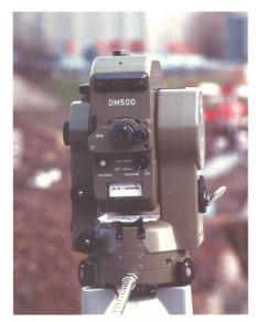
Abb. 6: KERN DM-500/501. Obwohl die gemessene Distanz noch reduziert werden musste (Rückschritt) und die Höhenunterschiede separat berechnet werden mussten, war nun die Aera der mechanisch-optischen Tachymeter endgültig Vergangenheit.
