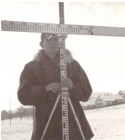
Abb. 4: Auf dieser Aluminium-Messlatte wurden die ganzen Meter der Horizontalabstände direkt abgelesen. Die cm-Einheiten erschienen nach dem Koinzidieren der verschobenen Lattenbilder direkt auf einer Mikrometertrommel neben dem Fernrohrokular. Geübte Vermesser erzielten mit diesem Gerät spielend eine Genauigkeit von +/- 1 cm/100 m.
