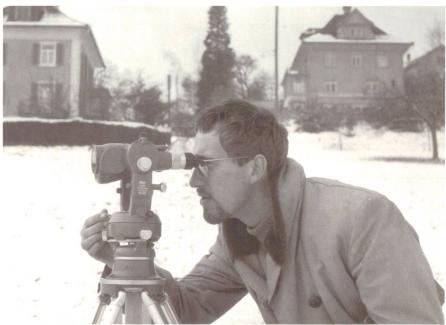
Abb. 5: Anfang der 60er-Jahre erfolgte mit der Markteinführung des KERN DK-RT (Doppelkreisreduktions-Tachymeter) ein echter Quantensprung in der Messtechnik. Hohe Genauigkeit, komfortable Handhabung und speditives Arbeiten waren die hervorstechenden Eigenschaften dieses Gerätes, welches bis zur Verbreitung der elektronischen Distanzmesser den Markt beherrschte.
