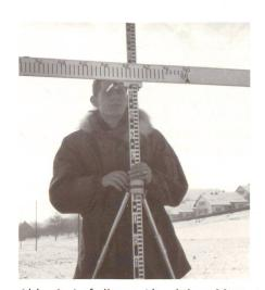
Abb. 4: Auf dieser Aluminium-Messlatte wurden die ganzen Meter der Horizontaldistanz direkt abgelesen. Die cm-Einheiten erschienen nach dem Koinzidieren der verschobenen Lattenbilder direkt auf einer Mikrometertrommel neben dem Fernrohrokular. Geübte Vermesser erzielten mit diesem Gerät spielend eine Genauigkeit von +/- 1 cm/100 m.
