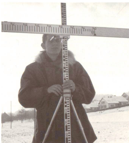
Abb. 4: Auf dieser Aluminium-Messlatte wurden die ganzen Meter der Horizontalstanz direkt abgelesen. Die cm-Einheiten erschienen nach dem Koinzidieren der verschobenen Lattenbilder direkt auf einer Mikrometertrommel neben dem Fernrohrokular. Geübte Vermesser erzielten mit diesem Gerät spielend eine Genauigkeit von \pm 1 \text{ cm}/100 \text{ m} .
