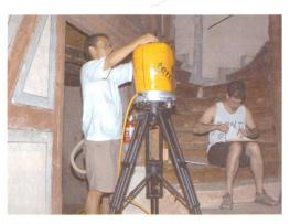
Abb. 3: Studierende beim Einsatz eines Callidus Laserscanners (terra vermessungen, Zürich) – Aufnahmearbeiten für das 3D-Modell von Schloss Wildenstein, Bubendorf/BL.
