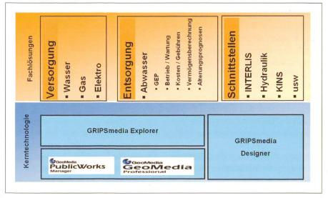
Abb. 10: Systemaufbau GRIPSmedia mit Fachschalen und Schnittstellen.
