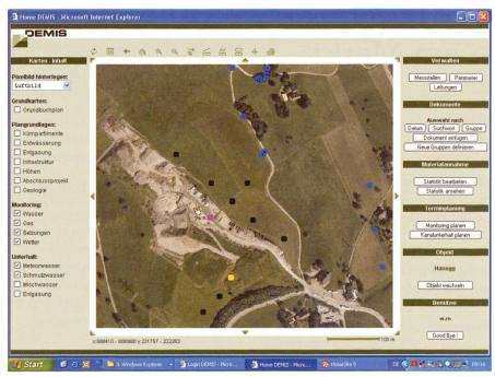
Abb. 24: Da die Daten geografisch mit Plänen verknüpft sind, kann auch intuitiv durch Klick auf einem Situationsplan auf sie zugegriffen werden. Die Deponie Hanegg in Horgen.
