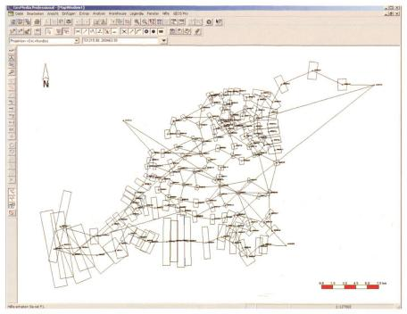
Abb. 2: Netzplan kombinierte Ausgleichung mit Zuverlässigkeitsrechtecken.
