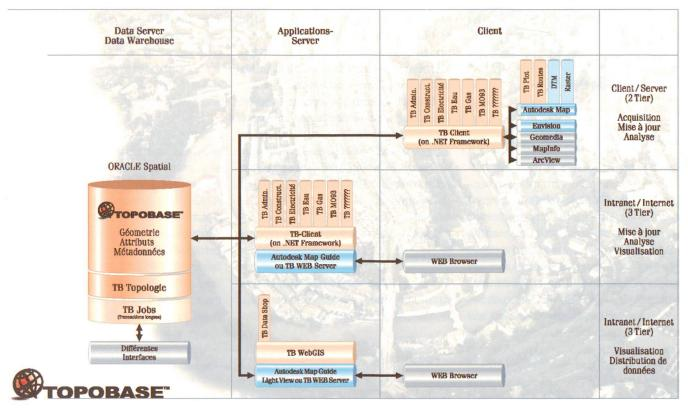
Fig. 1: Architecture système de TOPOBASE™.
