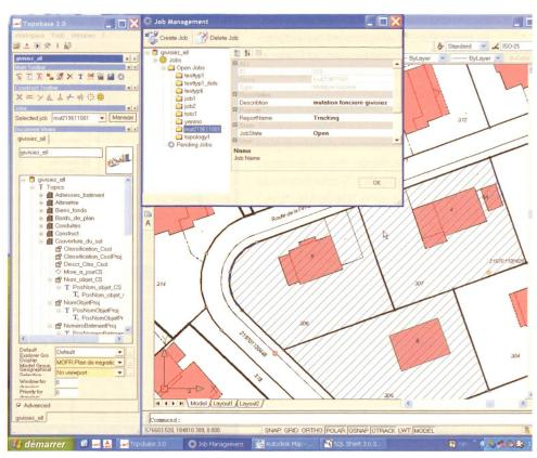
Fig. 2: Ouverture d'une mutation foncière avec le nouveau gestionnaire de mutation développé en .NET.
