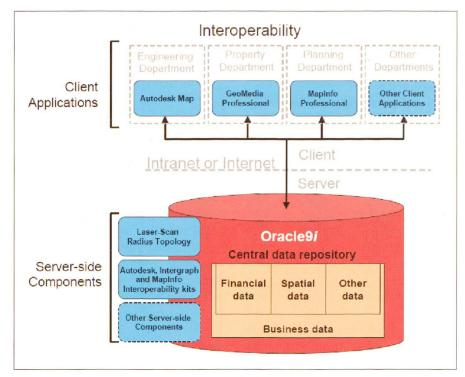
Abb. 1: Interoperability-Programm - Systemaufbau.
