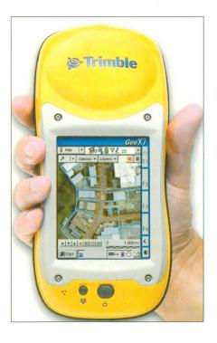
zusätzlich Geoinformationen von Datenservern beziehen. Diese Daten können als Hintergrundkarte verwendet werden, welche sich bezüglich aktueller Position sowie dem Zoomlevel (Informationsgehalt) laufend automatisch anpassen. Des Weiteren besteht die Möglichkeit, den Datenbestand auf dem Server direkt vom Feld aus nachzuführen.
