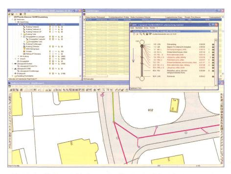
Abb. 14: Applikationseinbindung – Applikation KINS für Schadenauswertung und Sanierungsplanung.
