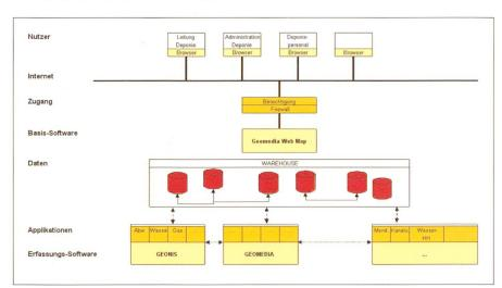
Abb. 22: Daten unterschiedlichster Herkunft werden im DEMIS auf einem Server abgelegt und können über einen normalen Internetzugang bearbeitet und abgerufen werden.
