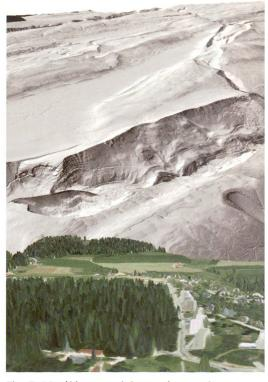
Fig. 5: Modèles numériques de terrain par balayage laser.
