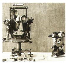
Abb. 1: Links: Ein Repetitionstheodolit, wie ihn Heinrich Wild noch auf den Dents-du-Midi benutzte. Rechts: Der kleine Theodolit Wild T2 ist der Urtyp aller modernen Vermessungsgeräte.
