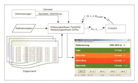
Abb. 3: Funktionsprinzip der Gleisabsteckung mit GriPos.
