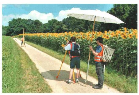
Abb. 1: Klasse G2: Präzisionsnivellement im Deformationsnetz Margelacker/Muttenz.
