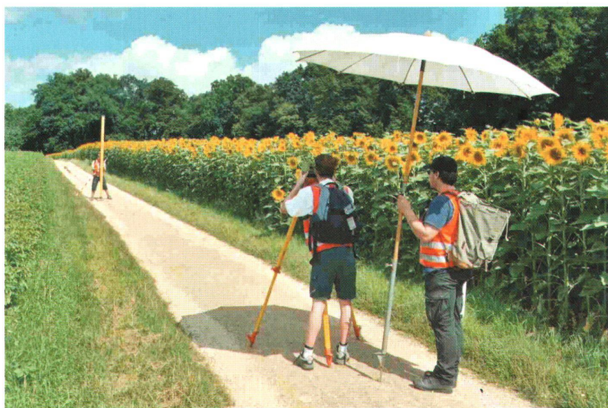
Abb. 1: Klasse G2: Präzisionsnivellement im Deformationsnetz Margelacker/Muttenz.
