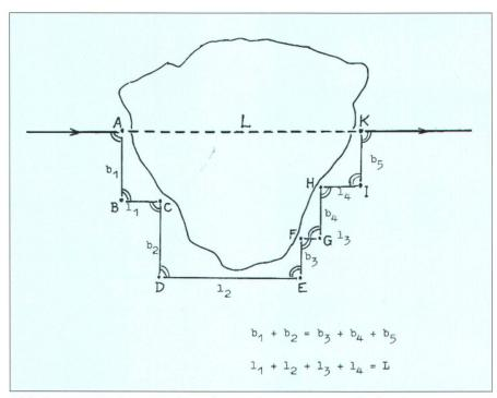
Abb. 3: Vermessung unter Umgehung eines grösseren Hindernisses.
