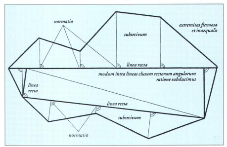
Abb. 2: Aufmessung eines unregelmässigen Grundstücks.
