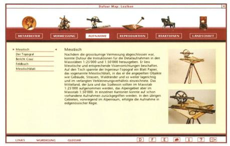
Abb. 4: Das Lexikon der Dufour Map enthält Kurzangaben zu verschiedenen Themen, hier zum Messtisch. Mittels Animationen kann beispielsweise der Ablauf eines Arbeitstages des Bündner Topografen Johann Coaz mitverfolgt oder die Übertragung der im Grossen Moos gemessenen Basis auf die Seite Rötifluh-Chasseral der «Triangulation primordiale» studiert werden (© swisstopo).
