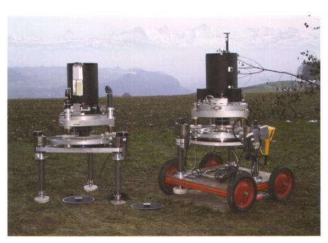
Abb. 8: Zenitkamera-Messungen zur Bestimmung des neusten Geoidmodells CHGeo2003: Simultanmessungen in Zimmerwald mit digitalen Geräten des Instituts für Erdmessung, Uni Hannover, und des Instituts für Geodäsie und Photogrammetrie der ETHZ.
