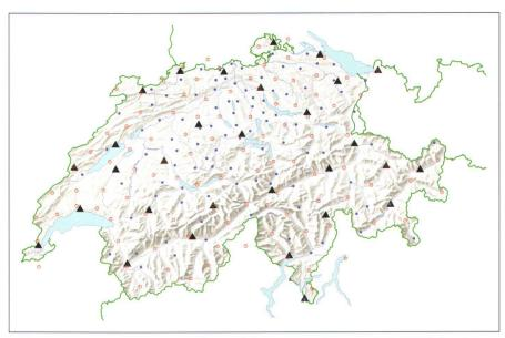
Abb. 5: LV95-Netz: Haupt- und Verdichtungspunkte sowie AGNES-Stationen (Dreiecke).
