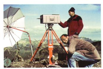
Abb. 3: EDM-Station (Laser-Geodimeter 8) Vorab.
