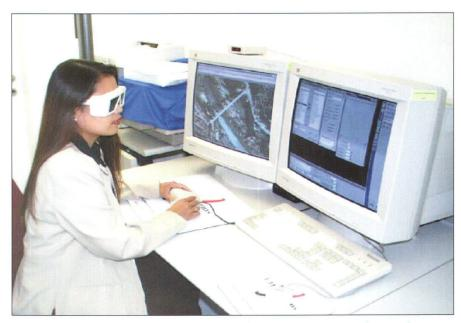
Abb. 4: Digitale Photogrammetrische Workstation LEICA DPW der Landestopographie. Digitales Modell mit teilweise automatischer Auswertung unter ausschliesslicher Verwendung von digitalen Bilddaten.
