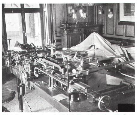
Abb. 1: Stereoautograph von Orell-Zeiss im Büro Helbling, Flums 1921. Erstes, in der Schweiz praktisch eingesetztes photogrammetrisches Stereoauswertegerät. (Alle Bilder © Swisstopo.)
