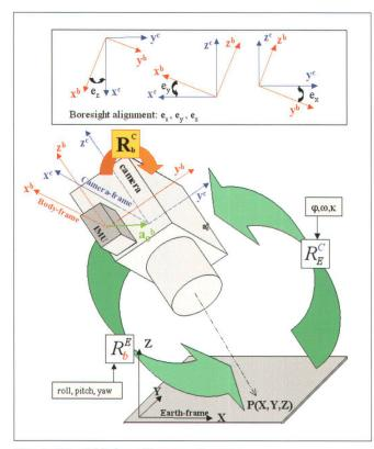
Fig. 1: Procédé de calibrage «2-step».
