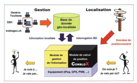
Fig. 2: Schéma simplifié de l'architecture du système d'information pour piétons.
