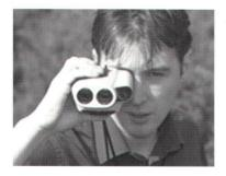
Dieses robuste, absolute Leichtgewicht (600 g) ist mit einem Entfernungs- und einem Neigungsmesser ausgestattet. Optional sind ein elektronischer 3D-Kompass oder elektronischer Winkelmesser erhältlich. Reichweite 300 m (mit Prismen bis 5 km).
