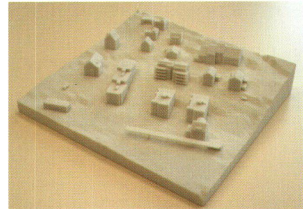
Abb. 5: DILAS-Export eines Bauprojekts als Klotzmodell, erzeugt durch einen 3D-Plotter (© Osterwalder, Lehmann Ingenieure und Geometer AG).
