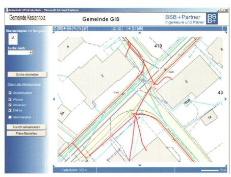
Abb. 7: Web-GIS Kestenholz: Ausschnitt aus Leitungskatasterplan.
