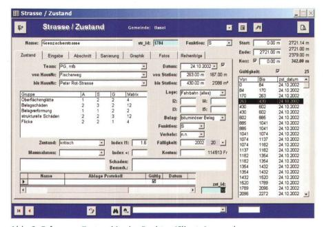
Abb. 3: Erfassung Zustand in der Desktop/Client-Anwendung.
