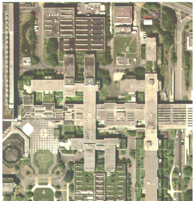
Abb. 11 und 12: Links: Orthophoto (Gebäude mit sichtbaren Fassaden). Rechts: True-Orthophoto (alle Objekte senkrecht).
