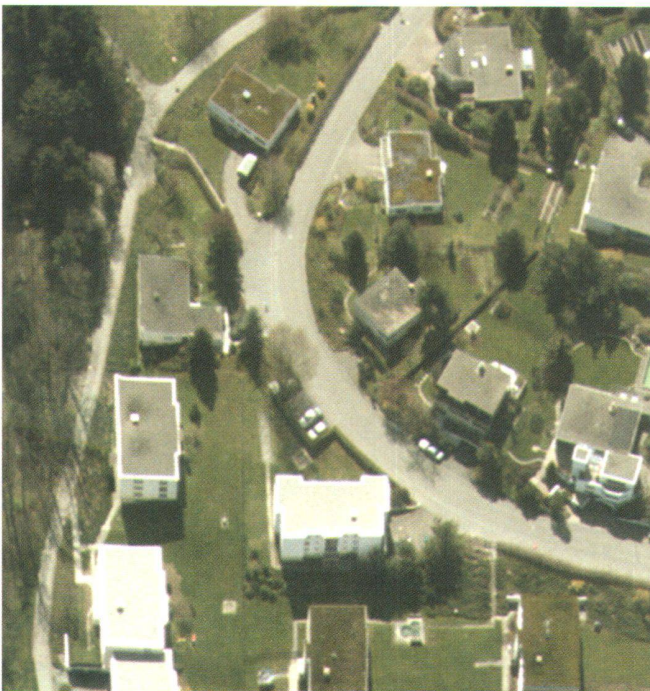
Abb. 11 und 12: Links: Orthophoto (Gebäude mit sichtbaren Fassaden). Rechts: True-Orthophoto (alle Objekte senkrecht).
