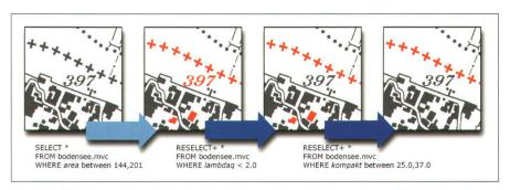
Abb. 5: Objektmerkmalsbasierte Abfrage für die Grenzlinie: Die hintereinander ausgeführten Abfragen nach den Merkmale Fläche (area), Hauptachsenverhältnis (lambdaq) und Kompaktheit (kompakt) führen zur sukzessiven Eingrenzung des Resultats.
