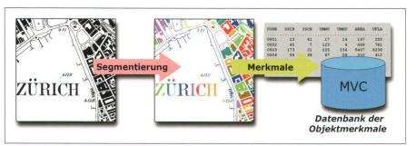
Abb. 4: Segmentierung und Berechnung von Objektmerkmalen.
