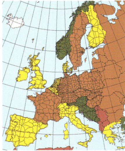
Abb. 5: Verwendete Höhensysteme in Europa und UELN-Netz: gelb: orthometrisch, braun: Normal, grün: normal-orthometrisch (aus Ihde/Augath, 1999 [3]).
