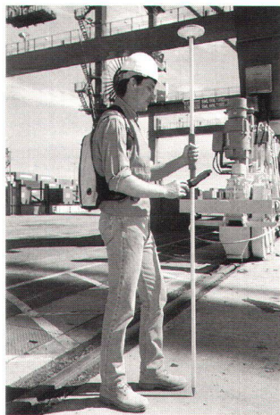
Echtzeit kinematische Messung mit dem SR530.
