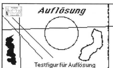
Abb. 1: Testfigur mit Pixeln von 0,35 mm, links oben auf 0,05 mm verkleinert.
