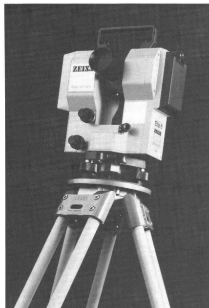
Elta 6 von Carl Zeiss, Oberkochen – der Einstieg in die elektronische Tachymetrie
