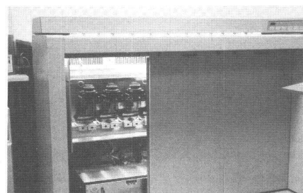
Abb. 12: Durchlaufscanner, Abtastung unten (Optigraphics) / Scanner avec balayage par ligne, sensor sous l'original
