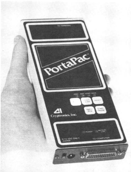
Das PortaPac ist ein äusserst kompaktes und handliches in Halbleitertechnik aufgebautes Datenspeicher- und Transfergerät. Seine Masse betragen H 25 x B 90 x T 231 mm. Die Robustheit verdankt es einem extrudierten Aluminiumgehäuse. Der Ni-Cad-Akku erlaubt 6 Stunden netzunabhängigen Betrieb. Pro Akkuladung können die Daten bis zu 6 Monaten im Speicher gehalten werden. Ein Ladegerät 220 VAC wird mit dem PortaPac mitgeliefert.
