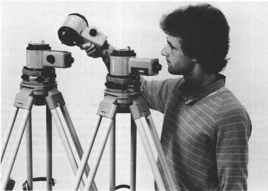
Das Wild ZNL wird in einem unverwüstlichen und wasserdichten Makrolon-Transportbehälter geliefert, in dem auch Dreifuss und Fadenkreuzbeleuchtung abschliessbar Platz finden. Für Hoch- und Tiefbau, Bergbau, Ingenieurbau, Landesvermessung und Industrie bietet dieses neue Instrument aus der Schweiz interessante Möglichkeiten. Es ergänzt das Wild-Programm der optischen Lotgeräte Wild ZL/NL, die mit ihrer Automatik auf  $\pm 0,5 \text{ mm}/100 \text{ m}$  die Vertikale bestimmen.
