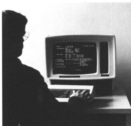
Abb.8 Über Datenterminals können Informationen der Grundstücksdatenbank abgerufen werden und geodätische Berechnungen aller Art durchgeführt werden
