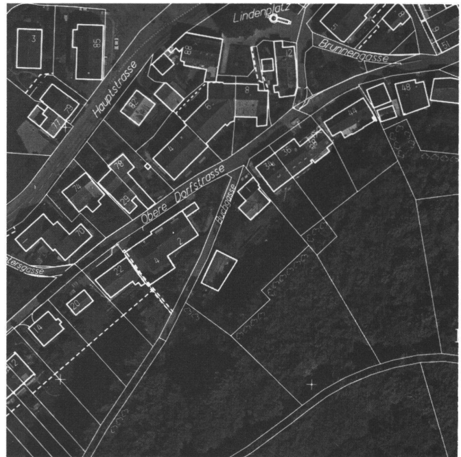
Abb.7b Kombination des Orthophotos 1:2000 mit dem digitalen Übersichtsplan
