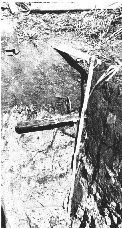
Abb. 3 Bodenprofil mit durchlässigem Humus- aber dichtem Lehmschicht
