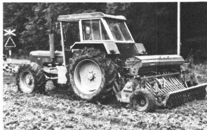
Abb. 6 Ansaat mit einer Fräs-Sä-Kombination in einem Arbeitsgang
