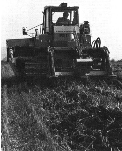
Abb. 1 Tieflockerungsmaschine, mit der die Versuchsfelder gelockert werden
