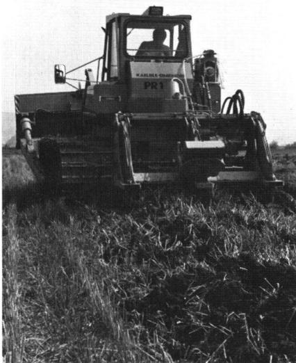
Abb. 1 Tieflockerungsmaschine, mit der die Versuchsfelder gelockert werden
