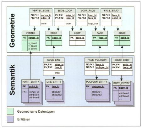
Abb. 3: Relationales Datenmodell einer topologischen 3D-GIS-Datenstruktur.
