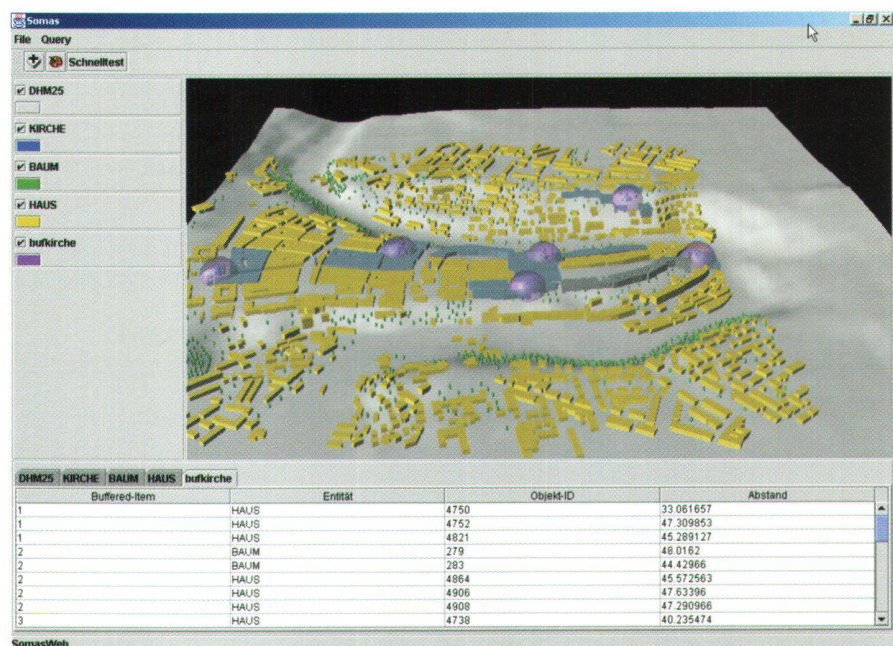
Abb. 5: Java-Client: Es wurden alle Gebäude selektiert und in eine neue temporäre Entität geschrieben, die innerhalb eines Buffers von 50 m um alle Kirchen liegen, die höher als 36 m sind.
