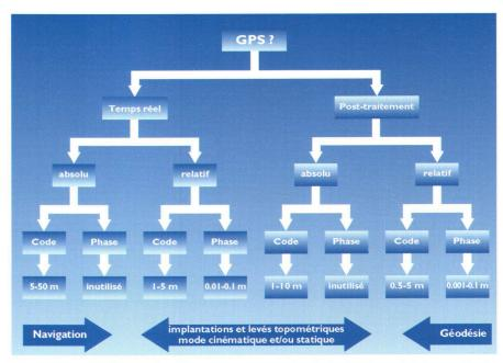
Fig. 3: Diverses façons d'utiliser GPS. De gauche à droite, la précision croît, de même que la difficulté logistique et le coût.
